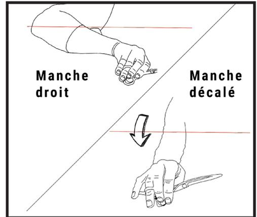
Le manche offset possède 2 anneaux désaxé ce qui optimise le positionnement du pouce pour la coupe. Ceci limite les risques de douleurs au canal carpien, et entraîne également une position plus confortable du bras.
